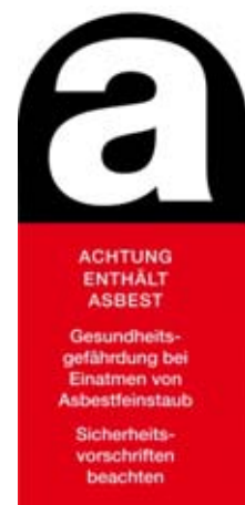
3 Kennzeichen «Achtung Asbest»
