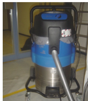
2 Industriestaubsauger mit Filter für Staubklasse H (Asbest)
