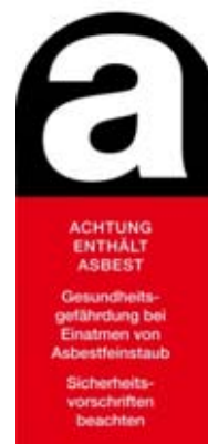
2 Kennzeichen «Achtung Asbest»
