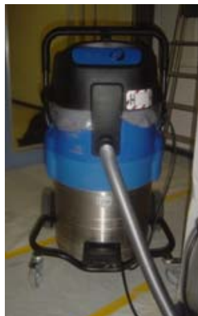
1 Staubsauger der Staubklasse H gemäss EN 60335-2-69, mit Zusatzanforderungen für Asbest
